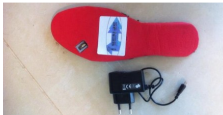
Projet ISENSE, une semelle intérieure connectée à un Smartphone avec une application Android.
